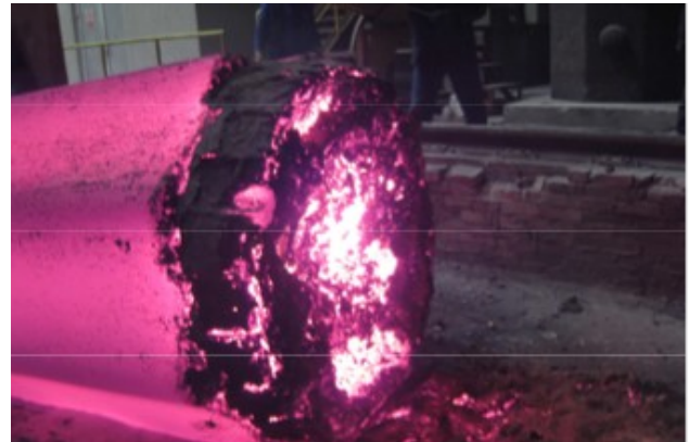
Vista lingotti colati in parallelo si noti a sinistra exoterm con l'aggiunta di polvere exo-iso L303MR dopo colaggio e a destra il lingotto trattato con metallurgia.
