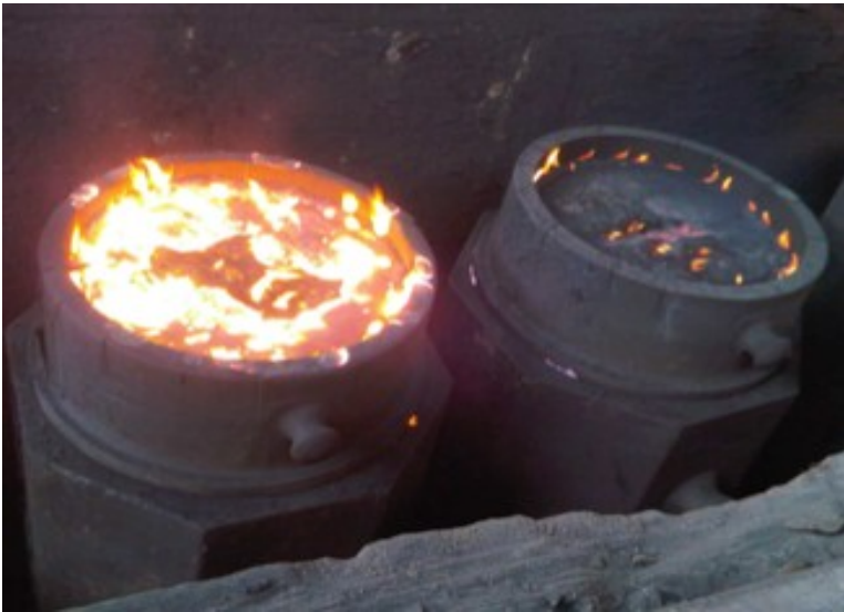
Vista lingotti colati in parallelo si noti a sinistra exoterm con l'aggiunta di polvere exo-iso L303MR dopo colaggio e a destra il lingotto trattato con metallurgia.
