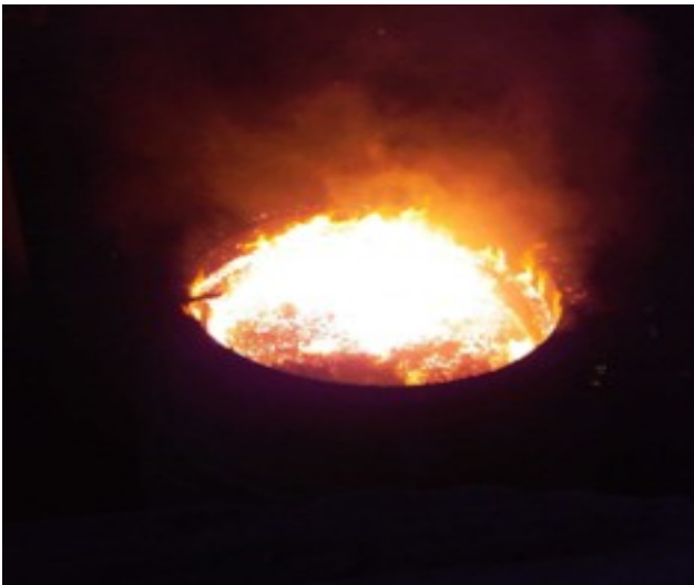
Fase di aggiunta polvere TL150 MR Reazione esotermica per il surriscaldamento della superficie.
