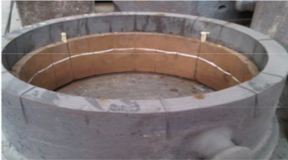
Portamaterozza originale h 450mm si nota materozza ridotta la linea bianca indica la linea di liquido h 300
