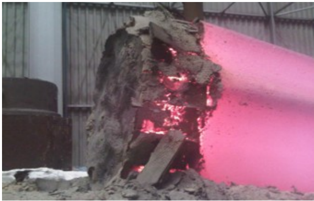
A sinistra lingotto dopo 9 ore di attesa in lingottiera A destra lingotto Exoterm con materozza ridotta
